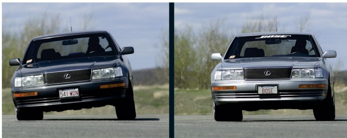
Figure 2 : Comportement d'un véhicule en virage sans suspension active (gauche) et avec (droite)
